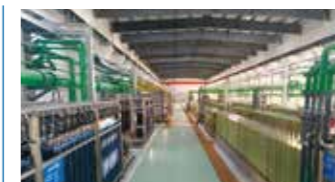
·“脱稳耦合平板膜”专利工艺包 首次成功投运建成矿井水示范 性项目 ·成功研制耐高温平板膜
